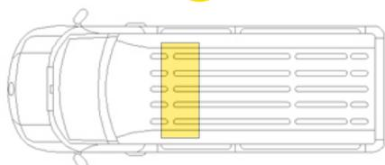
OPZIONE CONSIGLIATA PERCHÈ BILANCIATA NEI PESI SUGLI ASSI E LUNGO L'ASSE DEL VEICOLO. DI FACILE ACCESSO PER I COMANDI E PER L'UTILIZZO DELLE VARIE ENERGIE. IL LATO PER I CONTROLLI DELLA MACCHINA E LE MANUTENZIONI NECESSARIE SONO DI FACILE ISPEZIONE.
