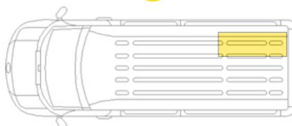
OPZIONE MENO ADATTA PER QUESTO TIPO DI MACCHINA PER QUELLO CHE RIGUARDA I PESI IN QUANTO TENDE A SBILANCIARE IL CARICO DEL VEICOLO SE NON PROPRIAMENTE BILANCIATO SUL LATO OPPOSTO DA OPPURTUNI ALLESTIMENTI.
